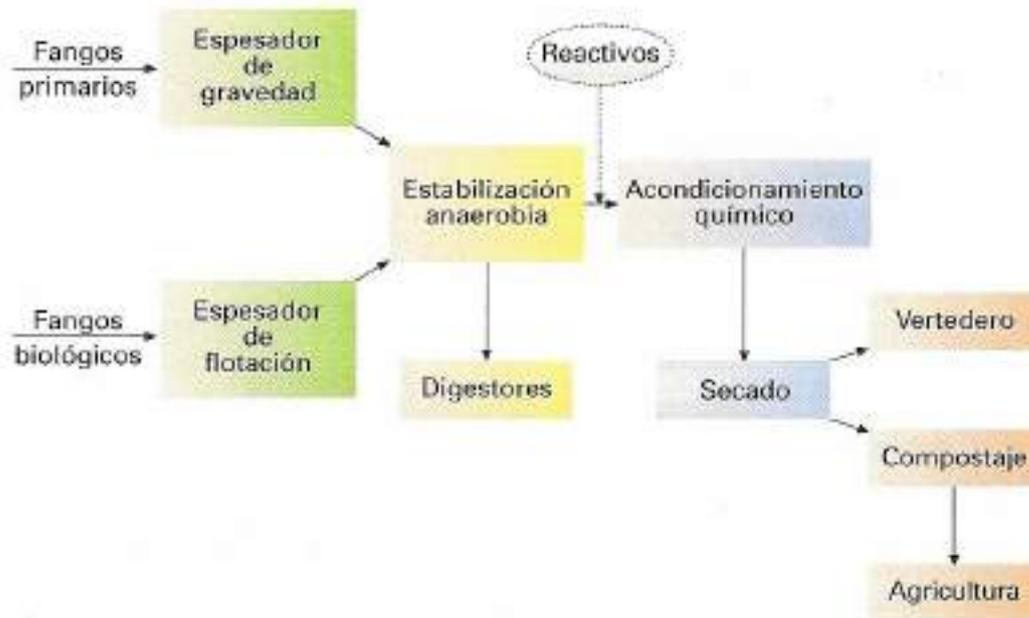
Esquema de la línea de fangos de una depuradora
